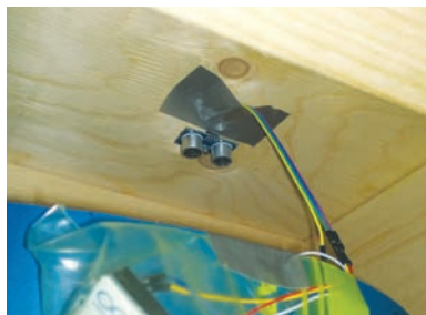
センサーもゴムテープでくっつけた。左側の筒が音波発信機、右が受信機。早い話、スピーカーとマイク。音が帰ってくるまでの数ミリ秒を数えて水面までの距離を測るのだ。
